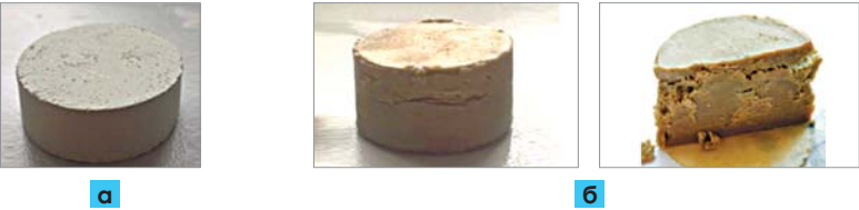
Рис. 3. Внешний вид глинистых таблеток до и после испытания: а – до начала эксперимента; б – по окончании эксперимента
